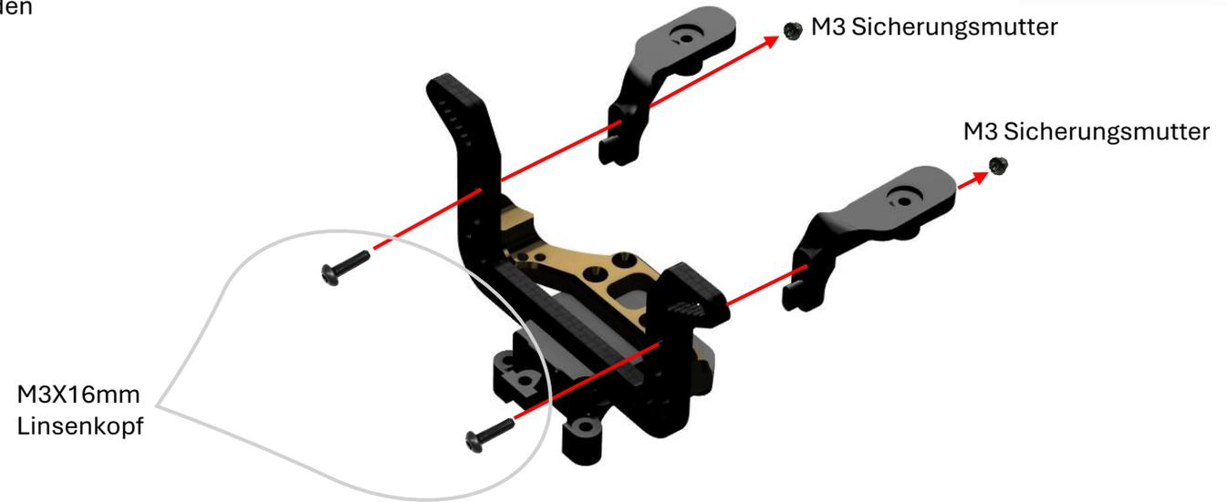
Die Stoßdämpfer werden mit dem Original Montagmaterial montiert.
